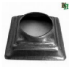
Переходник на трубу, арт. 8.808042 кв.80x80мм, переход на д=42x2мм Вес: 0.11 кг Цена: 58 руб.
